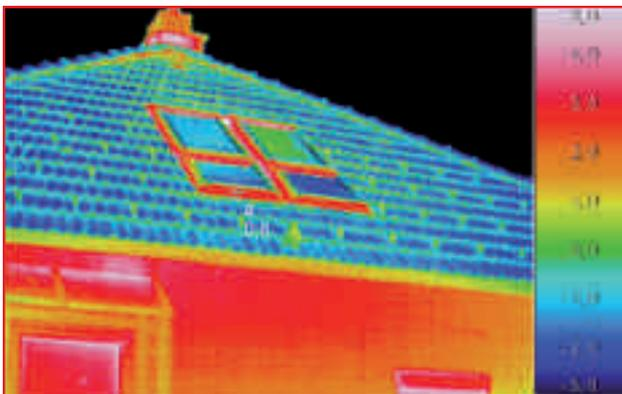
Beispiel: »Im Bereich des Rauchfangs sind Wärmeverluste erkennbar. Hohe Wärmeverluste gibt es auch an den Fensterrahmen der Dachflächenfenster. Diese wären auf Dichtigkeit zu prüfen. Weiters treten Verluste im Übergangsbereich zwischen Erdgeschoß und Dachgeschoß auf«
